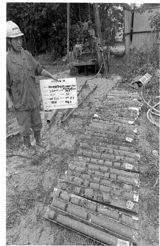
照片2-3 Z25孔岩心照片（较完整）
