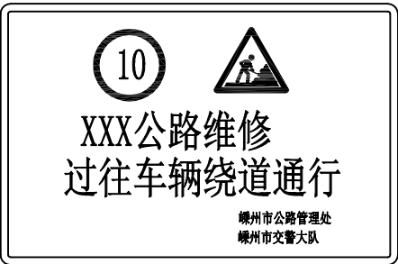
施工路段预告
